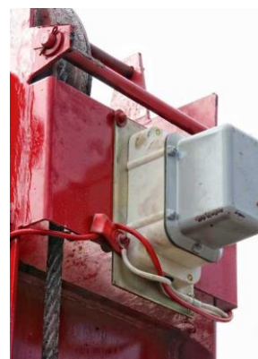
Сигнализатор опасного напряжения на оголовке основной стрелы
